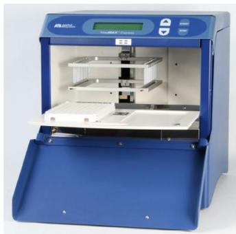
Les amplifications sont ensuite réalisées sur des appareils (thermocycleurs) pourvus de blocs chauffants, dans lesquels les cycles temps/températures sont contrôlés automatiquement.
